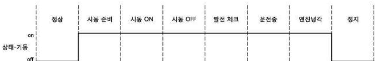
< 발전기 상태에 따른 [상태-기동] 출력 >
